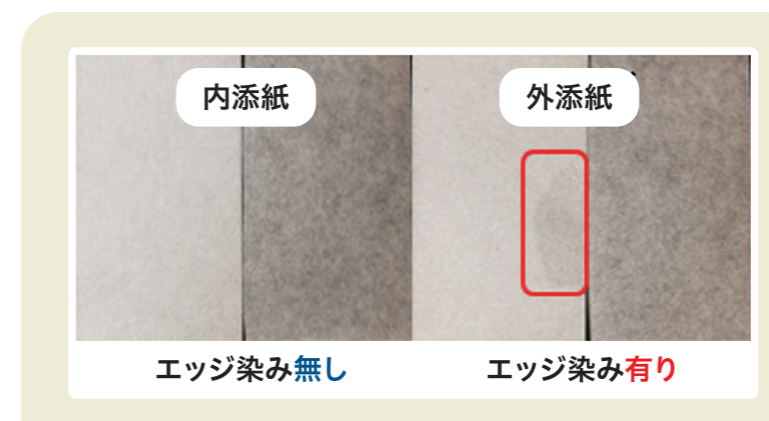
図5 内添紙(左)と外添紙(右)の端面(エッジ)耐油性の比較
