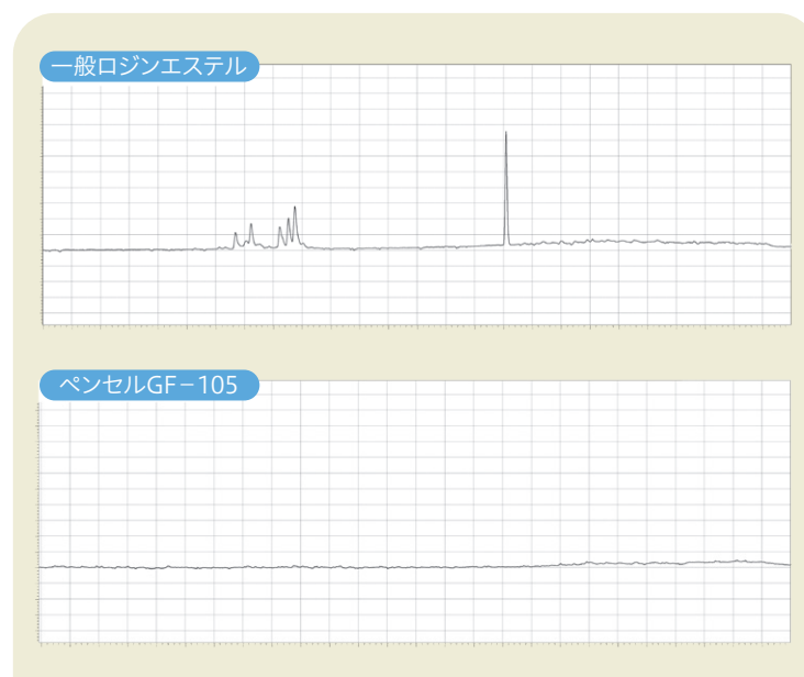
図3 ヘッドスペースGCによるVOC成分の分析 (カラム温度100°C以上の成分)
